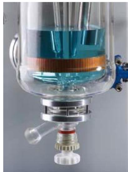
El flujo de calor medido se integra para todo el periodo de reacción con el fin de obtener un calor de reacción general. La cantidad de calor acumulado también es determinada como porcentaje del calor total liberado. El dato de flujo de calor se utiliza para calcular el aumento potencial de temperatura adiabática de la reacción. Esta es la temperatura que alcanzaría el reactor en caso de pérdida de refrigeración.
