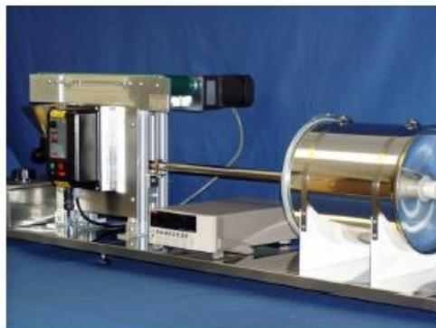
Equipo típico para el ensayo de la cargabilidad de polvo
