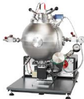
Equipo típico de severidad de explosión de 20L usado para la determinación de la CLO
