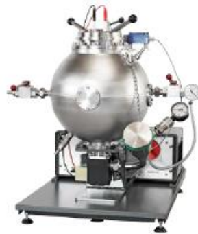
Equipo típico de severidad de explosión de 20L usado para la determinación de la CME
