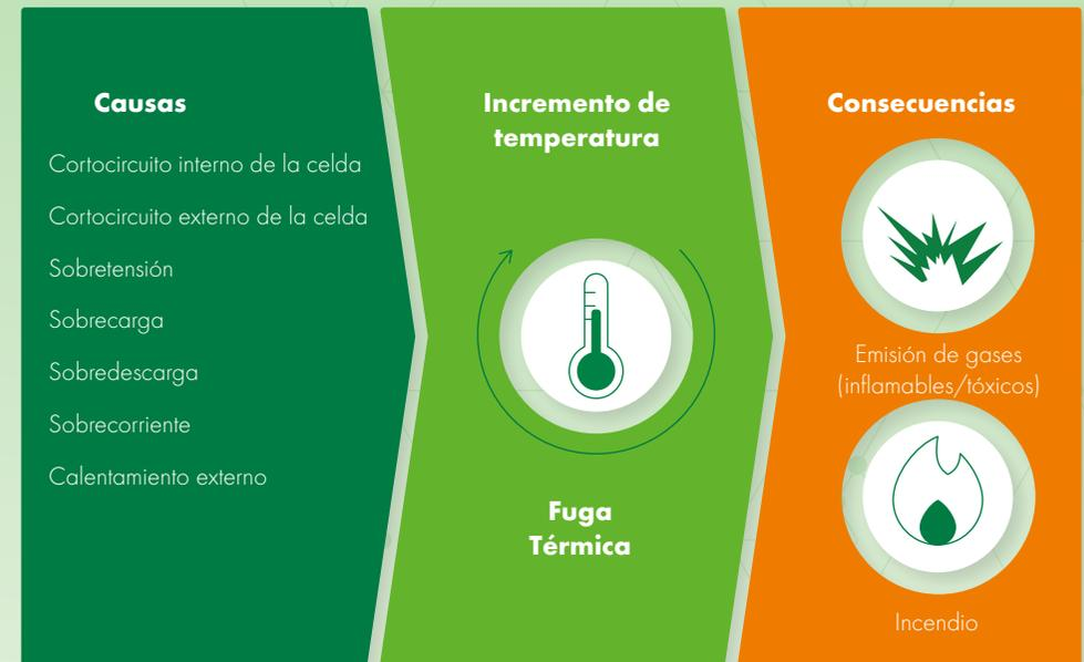
Figura 1. Causas de las reacciones térmicas fuera de control
