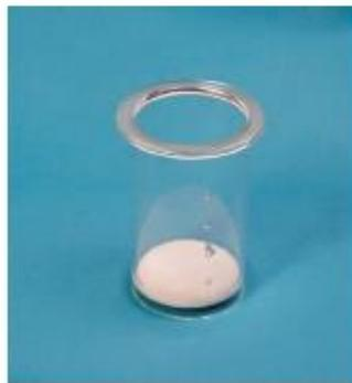
La mayor parte de las veces la reacción exotérmica y la ignición de la capa de polvo sucede por un proceso de autocalentamiento debido a la oxidación atmosférica. Cuando la temperatura de una capa de polvo alcanza un nivel suficiente, se pueden dar las condiciones en las cuales el calor generado por la reacción exotérmica es mayor que la pérdida de calor al entorno, y se desarrolla un fenómeno de aumento de temperatura.
