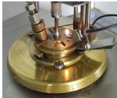
Típico aparato para determinar el punto de inflamación
