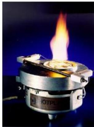
Equipo típico para el ensayo de la temperatura mínima de ignición en capa
