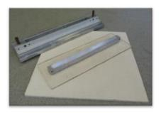
Si el tiempo de combustión en los ensayos preliminares de screening es menor a 2 minutos (20 minutos para polvos de metal o de aleaciones de metal) para una distancia de 200mm, se procede a realizar entonces el ensayo completo. De no ser así, no se requieren más ensayos.
