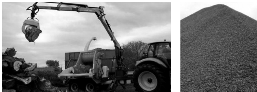
Fig. 1.1. i 1.2 Trinxat de soques per aprofitar-les com a biocombustible.
