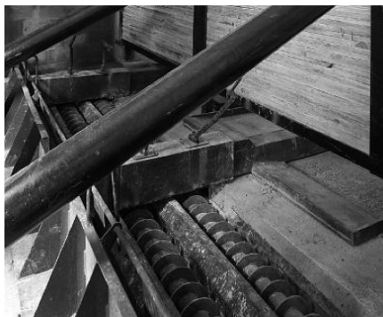
Fig. 5.11. Sitja amb terra mòbil. El mecanisme arrossega el biocombustible fins al fons de la sitja.
