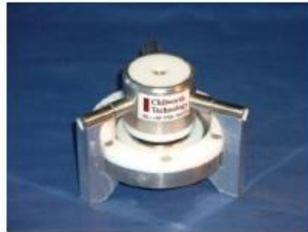
Celda típica del ensayo de resistividad volumétrica del polvo
