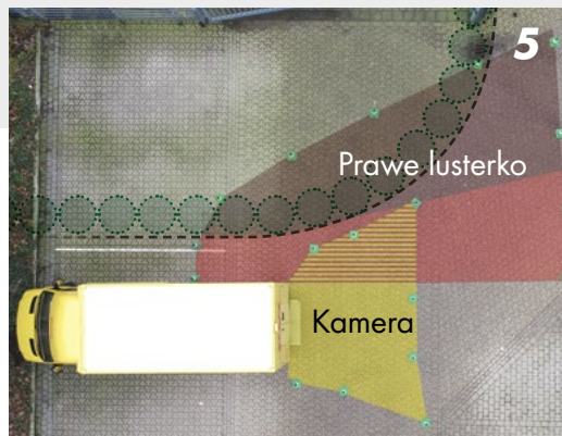
1 Szkic przebiegu wypadku i miejsca kolizji 2 Miejsce wypadku 3 Porównanie 4 Widok roweru typu Pedelec 5 Symulacja zakresu widoczności z kamery i prawego lusterka 6 Zakładany widok na sekundę przed kolizją
