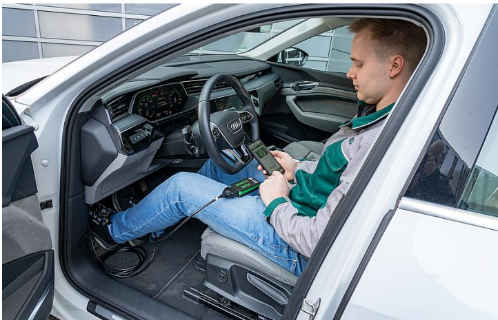
Neuer Batterie-Schnelltest: Der Alterungszustand („State of Health“) von Antriebsbatterien in Elektrofahrzeugen lässt sich mit dem patentierten DEKRA Verfahren in wenigen Minuten verlässlich prüfen (Bild: DEKRA)
