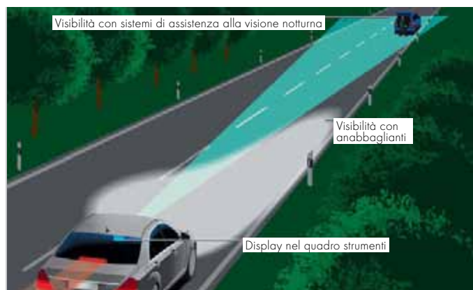
Confronto della portata degli anabbaglianti con quella dei sistemi di assistenza alla visione notturna.
