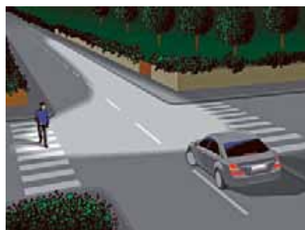
Campo visivo illuminato dalle luci di curva statica durante la svolta a sinistra.
