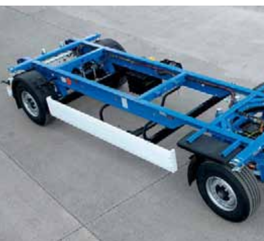
Le protezioni laterali vengono utilizzate per evitare che i pedoni o i ciclisti possano essere travolti.
