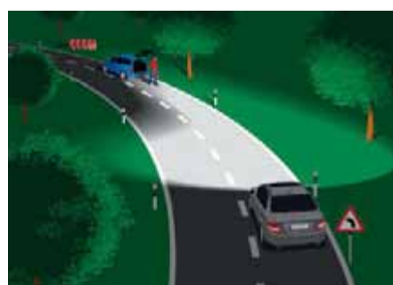
Campo visivo illuminato dalle luci di curva dinamica in una curva a sinistra.
