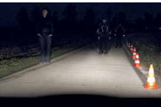
Anabbaglianti: le persone si trovano a 10, 15 e 25 metri di distanza
