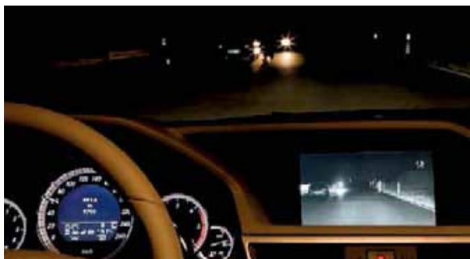
Visualizzazione dell'immagine registrata da una termocamera a infrarosso vicino sul display centrale.
