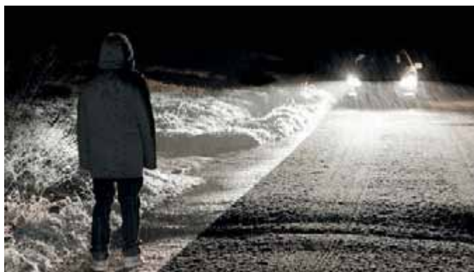
Con la funzione Spotlight, l'assistente alla visione notturna illumina automaticamente a breve intermittenza le persone la cui posizione viene riconosciuta come pericolosa.
