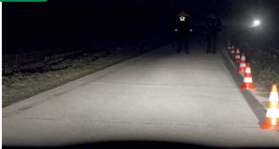
Due persone ad una distanza di 25 metri, con e senza riflettori. La seconda persona a destra si vede a malapena.
