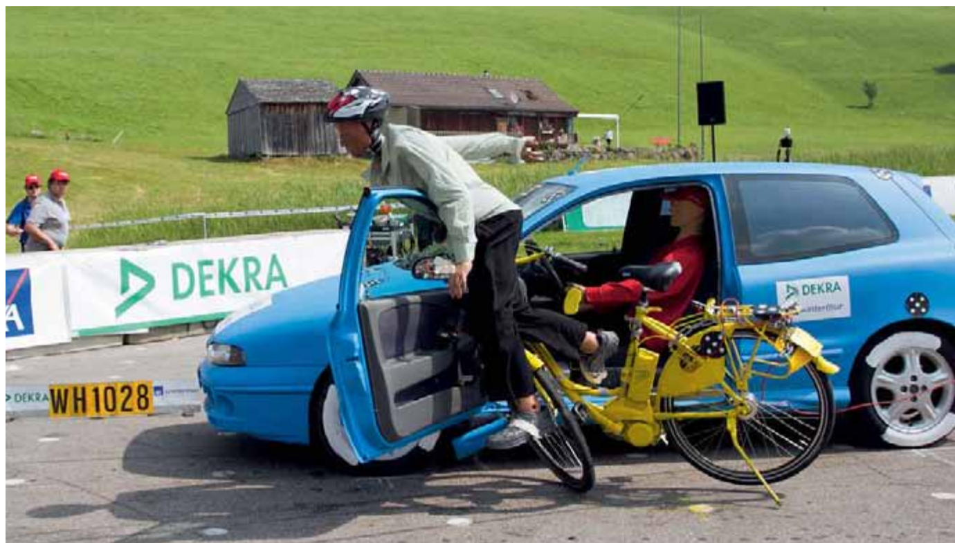
Crash Test 2010 di DEKRA e AXA Winterthur a Wildhaus, in Svizzera: La collisione con la porta in apertura provoca un arresto improvviso dell'e-bike.
