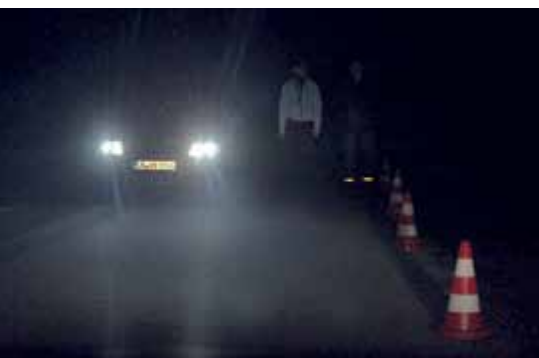
Anabbaglianti: entrambe le persone si trovano a 25 metri di distanza dal veicolo. Le giacche chiare e i riflettori migliorano la visibilità.
