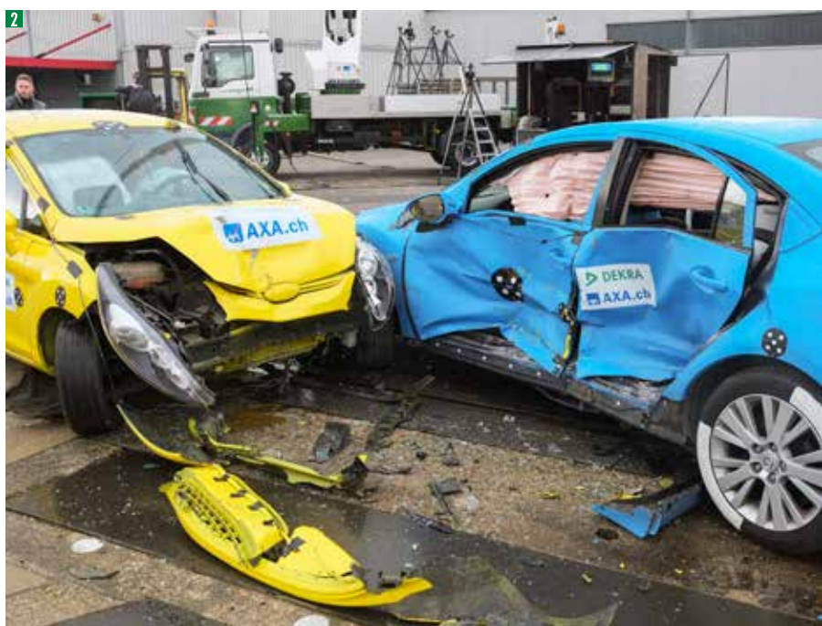
2 Gli airbag laterali integrati come pure il sottoporta stabile e il montante mediano proteggono perfettamente i passeggeri della Mazda.
