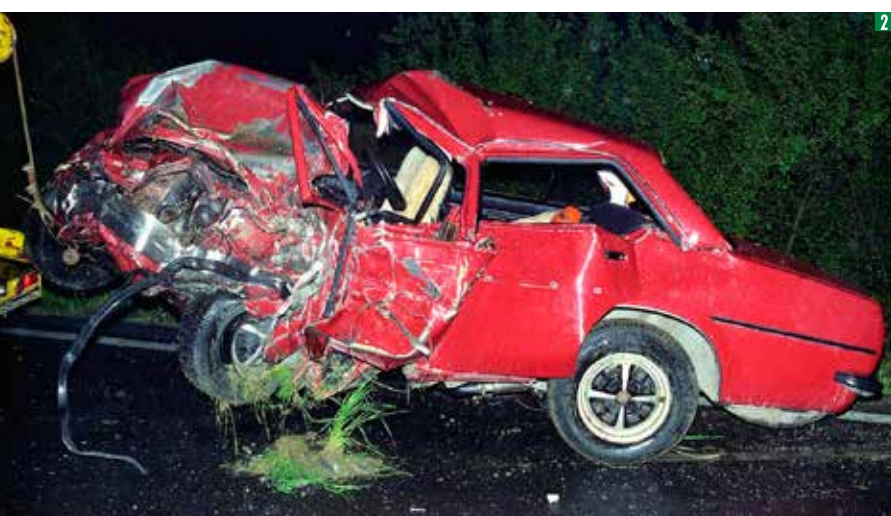
5 Avancorpo del veicolo deformato verso sinistra
