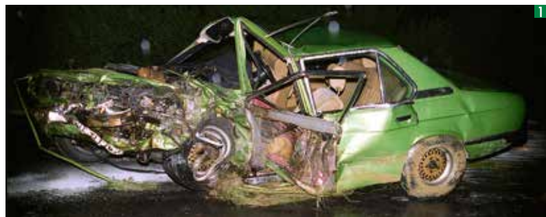
1 Cella dell'abitacolo della BMW quasi completamente compressa nell'area corrispondente al sedile del conducente, posizione eretta e penetrazione del piantone dello sterzo
