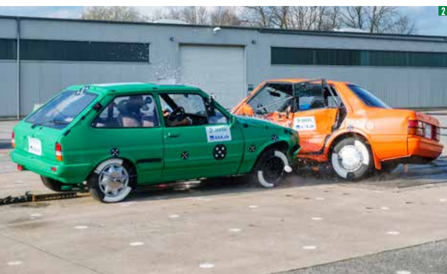
3 Danni ad entrambi i veicoli utilizzati nel crash test
