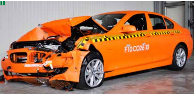
1 Danno al veicolo sottoposto a crash test a 64 km/h
