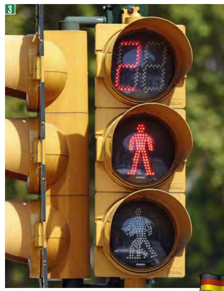
Semáforo para peões com indicação avançada do tempo restante para o sinal vermelho
