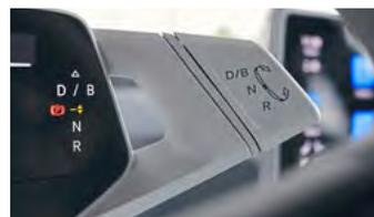
**Knubbel: Drehschalter zum Einlegen der Fahrstufen. Foto darüber: Kofferraum mit 385 bis 1267 Liter Volumen**
