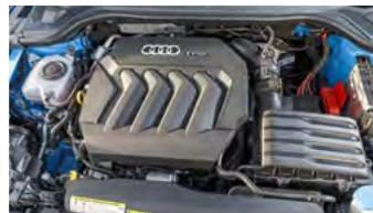
**Top-Aggregat: Der 2.0 TFSI leistete zu Beginn 200 PS, im April 2021 kamen 7 PS dazu. Nur 6,5 Sekunden von 0 auf 100 km/h!**
