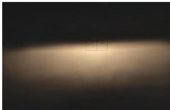
**So leuchtet die Halogenlampe von Eufab. Die Geometrie passt nicht, das funzelige Licht ist auffällig gelb, kurze Reichweite**
