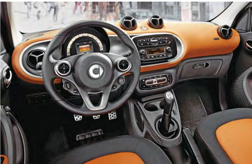
**Zentrales Kombi-Instrument für Tacho und Warnanzeigen, Propeller-Luftdüsen und farbenfrohe Individualisierungen**
