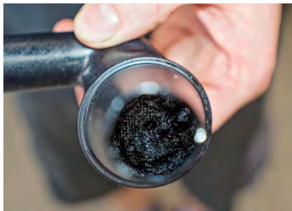
Infarktgefahr: Am Ansaugstutzen der Ölpumpe sammeln sich die Rückstände aus Gummischlamm
