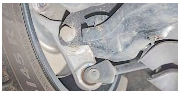
Thema Fahrwerk: Die hohen Gewichte der Antriebsbatterien strapazieren rasch die Gelenke
