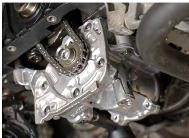
Nunmehr krisenfest: umgerüstete VW-Ölpumpe mit Kettensatz von MIK anstelle des Ölbad-Zahnriemens
