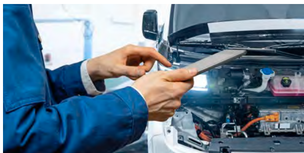
Batteriecheck per Diagnose: Der „State of Health“ (SOH) lässt sich elektronisch auslesen
