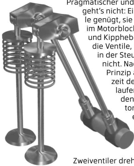
Pragmatischer und preiswerter geht's nicht: Eine Nockenwelle genügt, sie liegt zumeist im Motorblock. Stoßstangen und Kipphebel betätigen die Ventile, Freiheitsgrade in der Steuerung gibt es nicht. Nach diesem Prinzip aus der Frühzeit des Automobils laufen noch heute in den USA viele Motoren vom Band, etwa der V8 der aktuellen Chevrolet Stingray. Der Zweiventiler dreht nur bis 6600/min – die Stoßstangen sind der limitierende Faktor.
