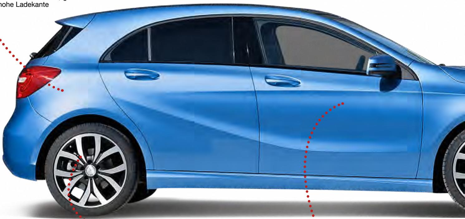
**Fahrwerk** Bei den ersten Modellen fiel die Fahrwerksabstimmung etwas zu straff aus. Mercedes reagierte und baute ab Mitte 2013 andere Dämpfer ein, was den Fahrkomfort spürbar verbesserte
