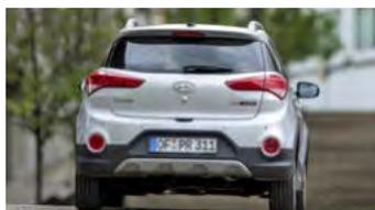
**i20 Active im Abenteuer-Trimm mit Unterfahrschutz, Dachreling, Rundumbeplankung und leicht angehobener Karosserie**
