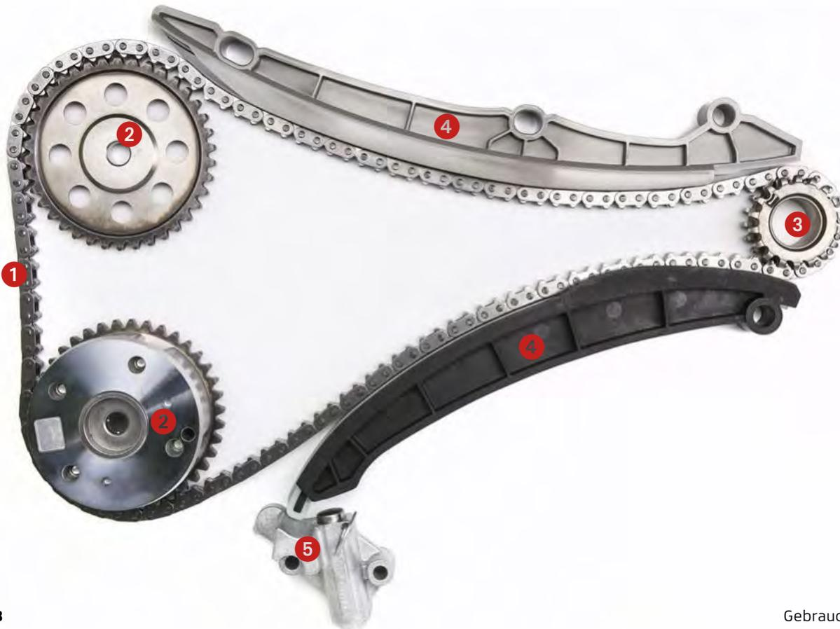
Bei einem DOHC-Vierzylinder in Reihenbauweise umläuft die Steuerkette (1) die beiden Nockenwellenräder (2), das untere im Bild ist verstellbar ausgeführt. Ihren Antrieb erhält die Kette vom kleinen Zahnrad auf der Kurbelwelle (3). Die Kette läuft an reibungsarmen Gleitschienen (4) entlang. Ein hydraulischer Spanner (5) übt auf eine von ihnen Druck aus, damit die Kette definiert straff bleibt. Damit kann er eine gewisse Längung ausgleichen
