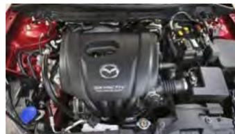
**Einer für alle: Den hoch verdichteten 1,5-Liter-Saugmotor gibt es in drei Leistungsstufen mit 75, 90 und 115 PS**
