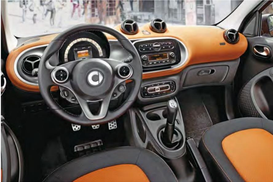
Zentrales Kombi-Instrument für Tacho und Warnanzeigen, Propeller-Luftdüsen und farbenfrohe Individualisierungen
