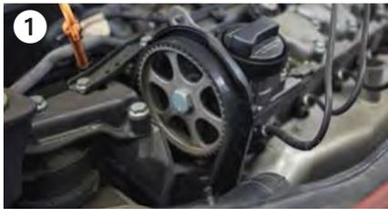
Der Zahnriemenwechsel beginnt mit der Demontage der Bauteile, die im Weg sind: Luftfilterkasten, Radhausschale, Zahnriemenabdeckung und Keilriemen. Um die Riemenscheibe zu erreichen, muss der Motor nach Ausbau seines rechten Lagers abgesenkt und unterstützt werden. Der Monteur lässt das Kühlwasser ab
