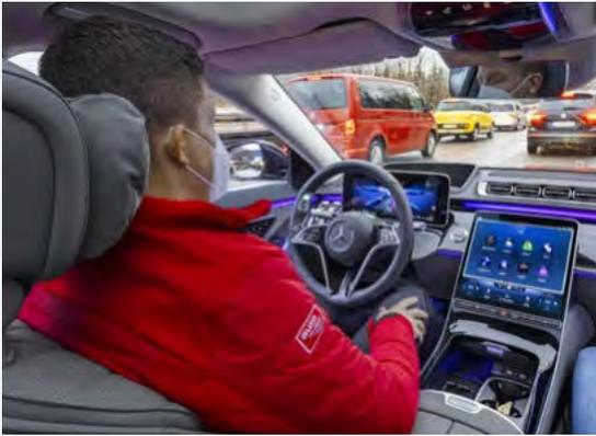
Mit einer Taste am Lenkrad wird der Drive Pilot aktiviert. Die Sensoren der bisherigen Assistenzsysteme werden u. a. durch Laserscanner und hochauflösende Karten ergänzt. Der Aufpreis in der S-Klasse beträgt knapp 6000 Euro
