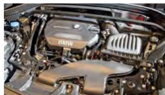
Die Motoren im X1 sind platzsparend quer eingebaut – wie bei der Schwestermarke Mini
