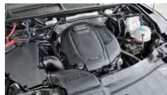
Längs eingebaute TDI- und TFSI-Aggregate mit vier oder sechs Zylindern. Leistungsspanne: 150 bis 354 PS
