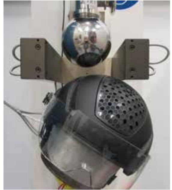
radhelme wiesen bei den Schlagprüfungen eine hohe Schutzwirkung auf. Die mit dem Testprojektil punktförmig eingeleitete Kraft wurde großflächig durch die Helmschalen und die Helmkonstruktion wirkungsvoll auf den am Kopf anliegenden Innenteil verteilt. Durch Deformationen und Brüche der Hartschäume der Helmschale wurde zudem Energie absorbiert und die auf den Kopf einwirkende Belastung weiter reduziert.
