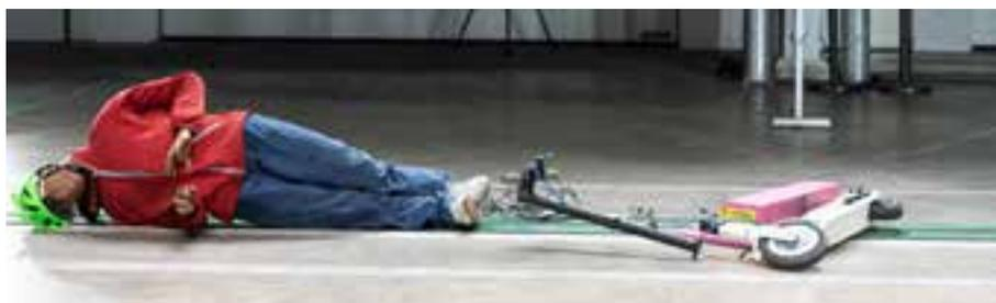
Beim Crashtest ohne Helm waren die beim Aufprall des Kopfes auf den Boden gemessenen Beschleunigungswerte sehr hoch – der HIC36-Wert lag bei 5.282. Bei dem im Versuch gemessenen Wert ist mit schwersten bis tödlichen Kopfverletzungen zu rechnen. Im zweiten Versuch trug der Dummy einen Fahrradhelm. Die Kopfbelastungen wurden
