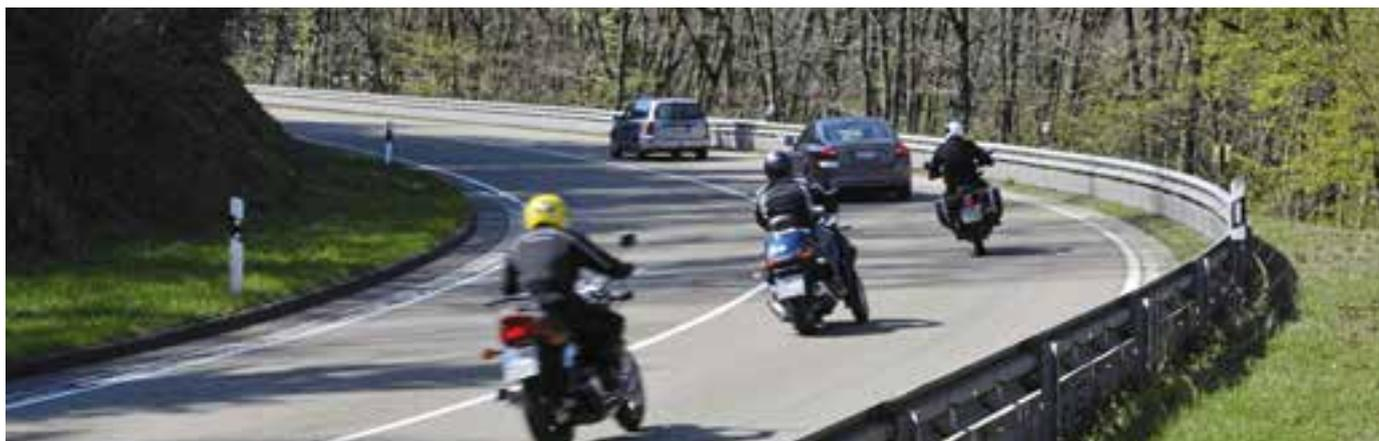
■ Schutzplanken mit Unterfahrschutz senken im Falle eines Anpralls das Verletzungsrisiko von Motorradfahrern.
