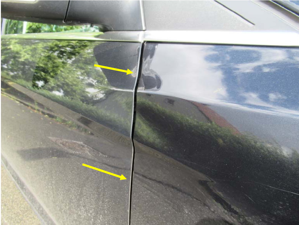
Farbtonunterschied Kotflügel – Tür an dem Fahrzeug des Beschuldigten
