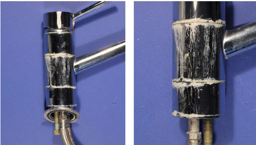
*Hier ein Einhebelmischer mit massiven Ablaufspuren (Kalkablagerungen), durch sie kam es zur Funktionsbeeinträchtigung der Dichtungen.*
