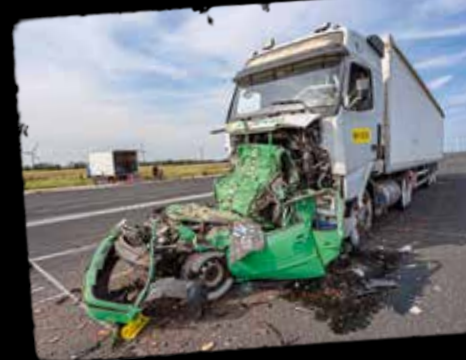
Alltag: Der Frontalaufprall mit seitlicher Überdeckung gehört zum Standardprogramm des CTC.
