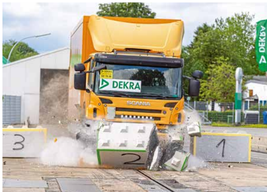
Stopp! Im Test müssen Anti-Terror-Barrieren tonnenschwere Lkw sicher aufhalten.
