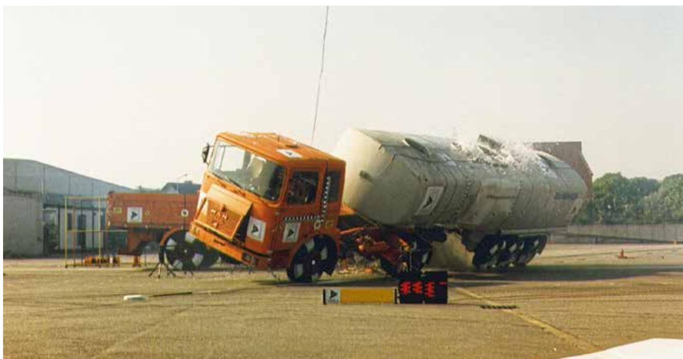
Auf der Kippe: Im Rahmen des Großforschungsprojekts THESEUS führte DEKRA Anfang der 1990er Jahre viele Lkw-Crashtests durch.
