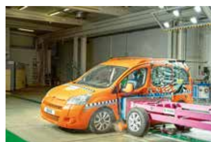
Seitencrash mit deformierbarer Barriere.
