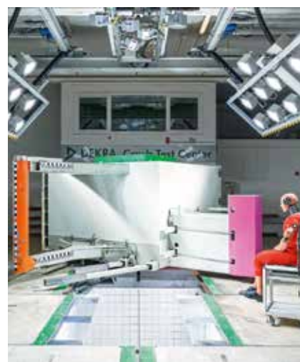
Das violette Element simuliert hier einen Pfahl, auf den ein Fahrzeug prallt.
