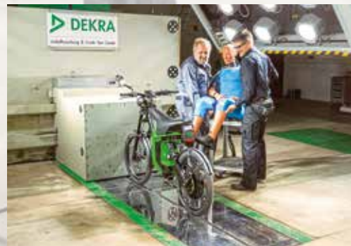
Aufgebaut: Techniker im CTC rüsten ein Elmoto Kleinkrafttrad für einen Crashtest auf.
