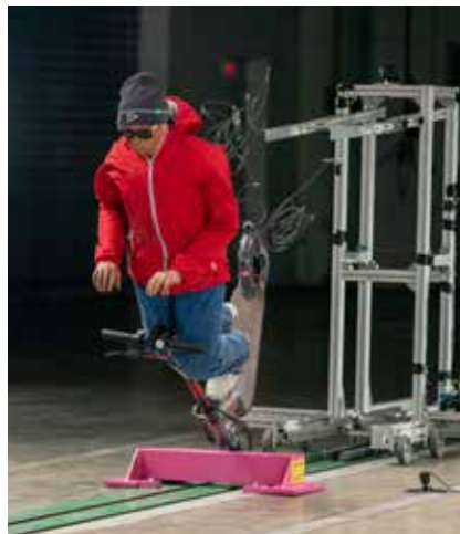
Mikromobile bergen neue Gefahren, wie hier beim Aufprall eines E-Scooters auf den Bordstein.
