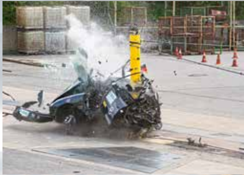
Früher war nicht alles besser: 2007 wird dieser Pkw beim Pfahlaufprall im CTC total zerstört.
