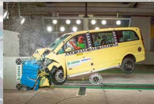
Alltag: Der Frontalaufprall mit seitlicher Überdeckung gehört zum Standardprogramm des CTC.
