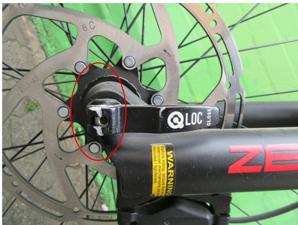
Bild 16 : Schnellspanner vorne verschrammt
