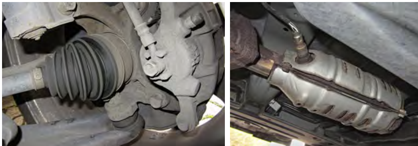
Poröse Bremsleitungen, rissige Staubmanschetten mit Fettaustritt, rostige Abschirmbleche am Auspuff: Mit der Kamera können auch Laien viele Problembereiche aufspüren und für Preisverhandlungen dokumentieren
