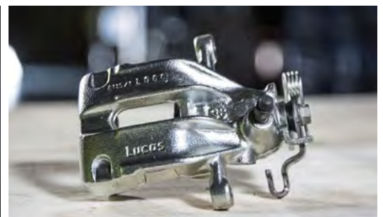
Glanzstück: Am Ende ist der bei ZF aufbereitete Bremsattel wieder voll einsatzfähig
