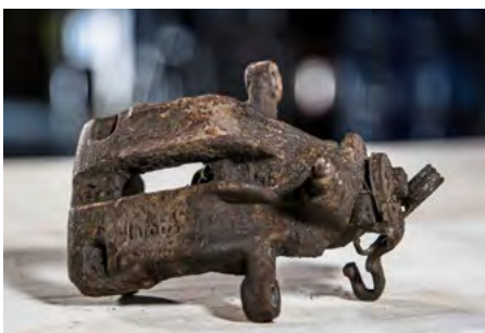
Sichtlich ergraut: So sieht ein Bremsattel nach seinem ersten Leben aus
