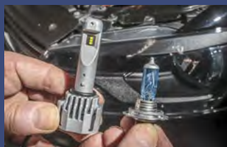
Nachrüst-LED mit Kühlkörper (links) ersetzt hier H7-Lampe
