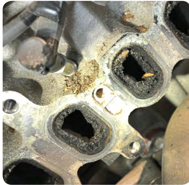
Ruß und Öl: stark verkokte Ansaugbrücke eines Mazda CX-5 mit Dieselmotor, der viel im Pendlerbetrieb unterwegs war
