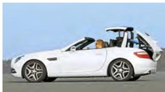
Das Dach klappt in 20 Sekunden, reduziert gefaltet aber das Kofferraumvolumen von 335 auf 225 Liter
