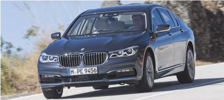
**D**er Eindruck täuscht nicht: Die sechste Generation des Siebener, die BMW von 2015 bis 2022 baute, wirkt optisch schlank und ist es auch. Der 750i mit 4,4-Liter-V8-Benziner und Allradantrieb wiegt 91 Kilogramm weniger als ein vergleichbar ausgestatteter Vorgänger. Die aufwendige Karosseriestruktur mit Carbonenlementen im Dachbereich zahlt sich also aus.
