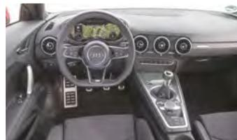
**Digitales Cockpit im TT: Alle Anzeigen im Kombiinstrument, Bedienung per Lenkrad oder Dreh-/Drück-Steller**
