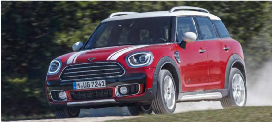
**A**lles andere als mini war das Größenwachstum beim Countryman der zweiten Generation (F60), gebaut von 2017 bis Ende 2023. Mit zwanzig Zentimetern Längenzuwachs und einem Plus von 7,5 sowie 3,5 Zentimetern bei Radstand und Breite streckte sich der SUV auf Kompaktklasseformat. Der F60 teilte sich die Technik und die UKL2-Plattform mit dem BMW X1 des Typs F48, was mit einem entsprechenden Zuschlag bei Gewicht und Preis einherging.
