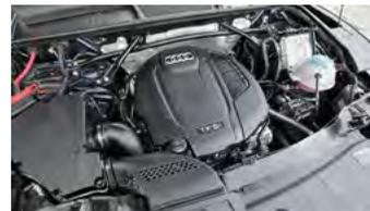
Längs eingebaute TDI- und TFSI-Aggregate mit vier oder sechs Zylindern. Leistung von 150 bis 354 PS (SQ5 TFSI)
