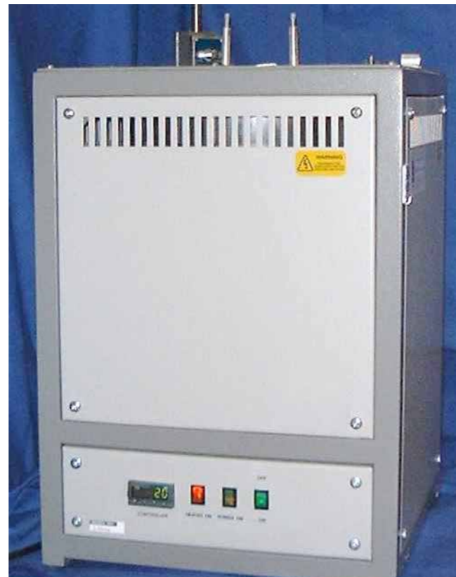
Auto Ignition Test Apparatus
