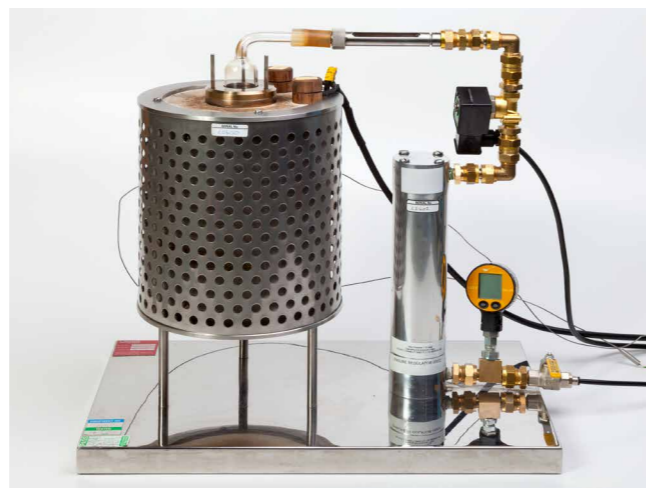
MIT Cloud Apparatus
