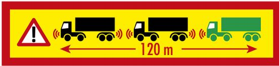
■ Beispiel für die Anzeige auf dem elektronischen Heckdisplay an der letzten Fahrzeugkombination eines Platooning-Verbandes
