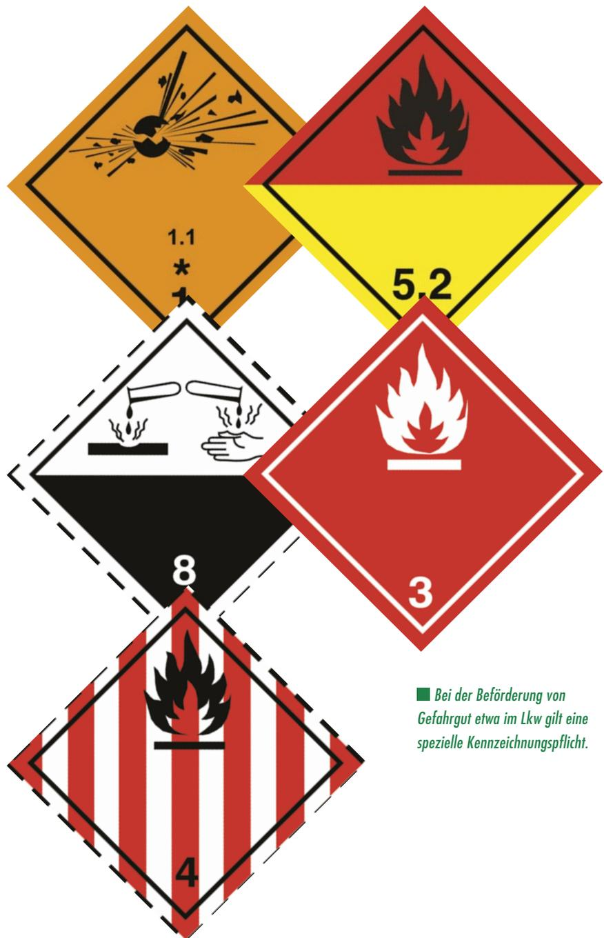
■ Bei der Beförderung von Gefahrgut etwa im Lkw gilt eine spezielle Kennzeichnungspflicht.
