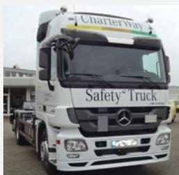
**2006** Daimler präsentiert den „Safety Truck“ mit Abstandsregelsystem, Spurassistent, Stabilitätsregelung und dem Notbremsassistenten Active Brake Assist (ABA)
