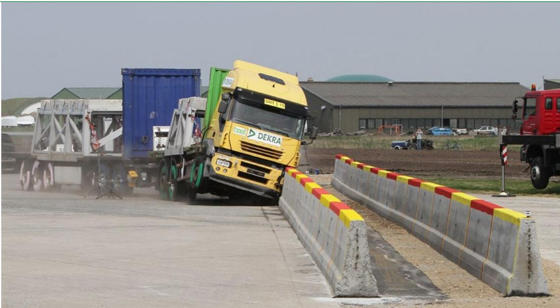
■ Lang-Lkw-Crashtests von DEKRA im Auftrag der Bundesanstalt für Straßenwesen: Der 38 Tonnen schwere Lang-Lkw hat die zweireihig aufgestellte Schutzeinrichtung aus Beton der höchsten Aufhaltestufe nicht durchbrochen.
