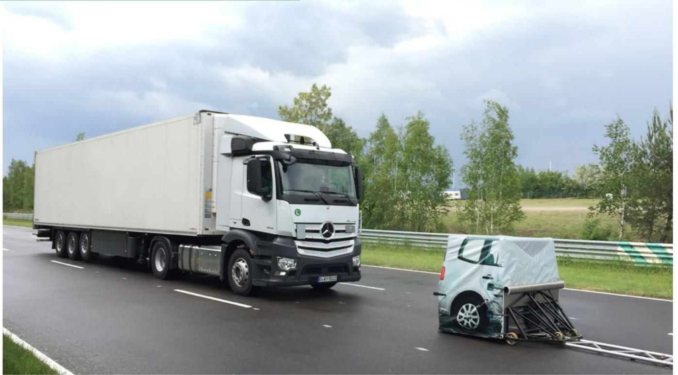
■ DEKRA testete im Frühjahr 2018 im Technology Center in Klettwitz die Potenziale und Grenzen aktueller automatischer Lkw-Notbremsassistenten. Die Ergebnisse werden im Lauf des Jahres vorgestellt.
