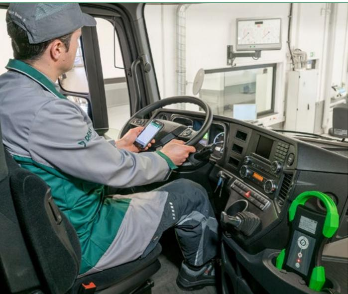
■ Der HU-Adapter zur elektronischen Funktionskontrolle wichtiger Komponenten hat sich in Deutschland auch bei schweren Nutzfahrzeugen bewährt. Vorbereitet wird aktuell die Ausweitung auf die Prüfung von Anhängern.
