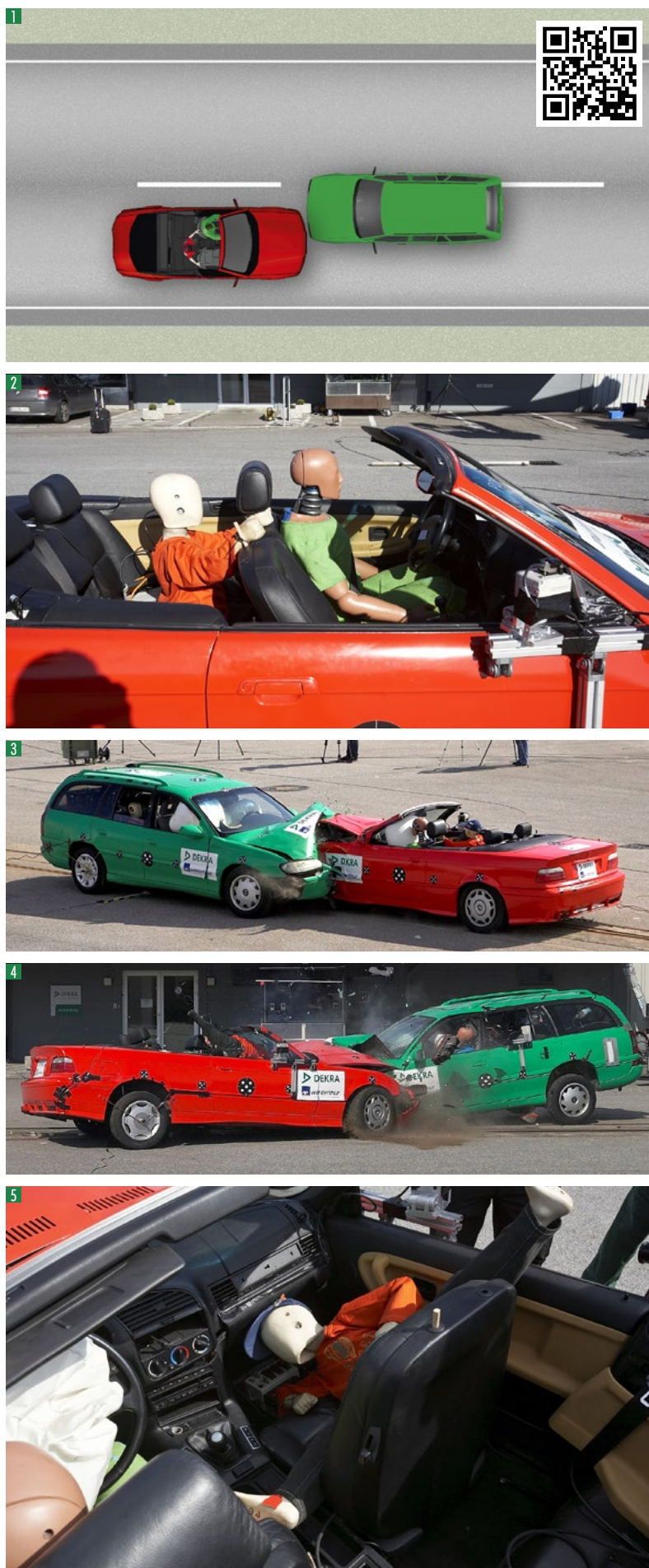
2 Position initiale des mannequins de test de collision dans le véhicule
