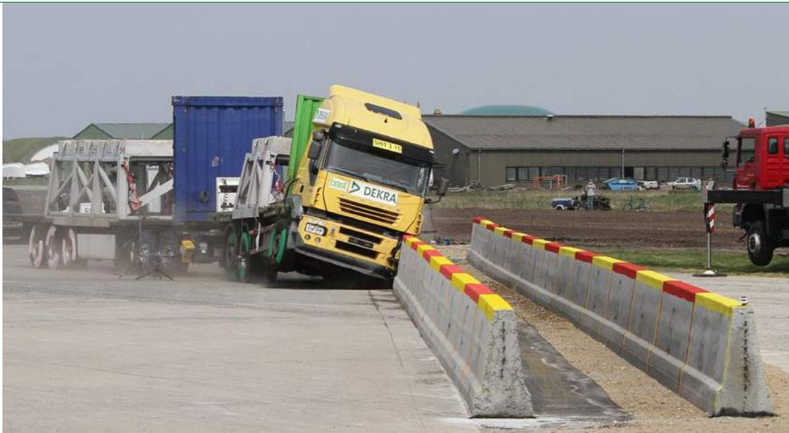
■ Prove d'urto su camion lunghi da parte di DEKRA su incarico dell'Ufficio federale tedesco per la rete stradale: l'autocarro lungo di 38 tonnellate non ha rotto la protezione di sicurezza in calcestruzzo a doppia fila con il massimo livello di contenimento.
