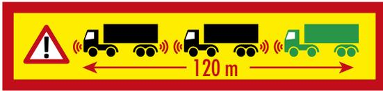
■ Esempio di visualizzazione sul display posteriore elettronico dell'ultima combinazione di veicolo di un'associazione di Platooning.
