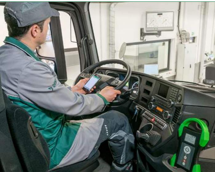
■ *L'adattatore HU per il controllo elettronico del funzionamento di componenti importanti si è affermato anche in Germania per i veicoli commerciali pesanti.*
