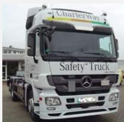
**2006** Daimler presenta il "Safety Truck" con sistema di controllo della distanza, assistente di corsia, controllo della stabilità e l'assistente di frenata d'emergenza Active Brake Assist (ABA)
