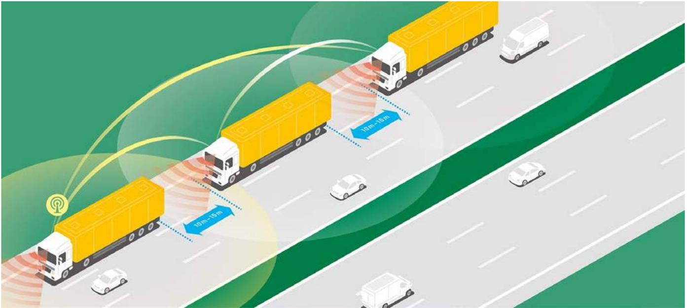
■ *Il Platooning consiste nel collegare in rete elettronicamente più autocarri che comunicano in tempo reale. Se i veicoli sono disposti in un convoglio, il veicolo di comando può trasferire il suo comportamento di guida agli altri. Questo permette al convoglio di eseguire manovre come l'accelerazione e la frenata in modo sincrono per tutti i veicoli.*
