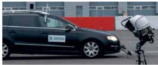
■ *Der Kinderwagen wurde beim DEKRA Test innerhalb der Reaktionszeit mit einer Geschwindigkeit von 50 km/h erfasst und mehrere Meter weggeschleudert.*
