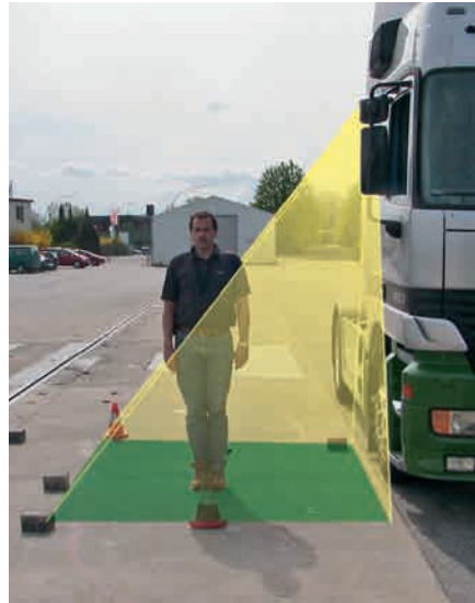
Vergleich alter und neuer Spiegel am Beispiel des Anfahrspiegels.
