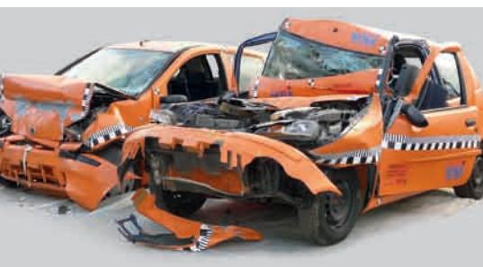
Wirksamer Seitenschutz: Beim Pkw-Anprall an die (bisherige) Standardpalettenbox ergeben sich Verformungen bis in den Bereich der Lehne des Fahrersitzes. Der Airbag löst nicht aus. Im anderen Fall kann die im Pkw eingebaute passive Sicherheit wirksam werden. Die Deformation endet vor der Frontscheibe. Der Airbag löst aus.
