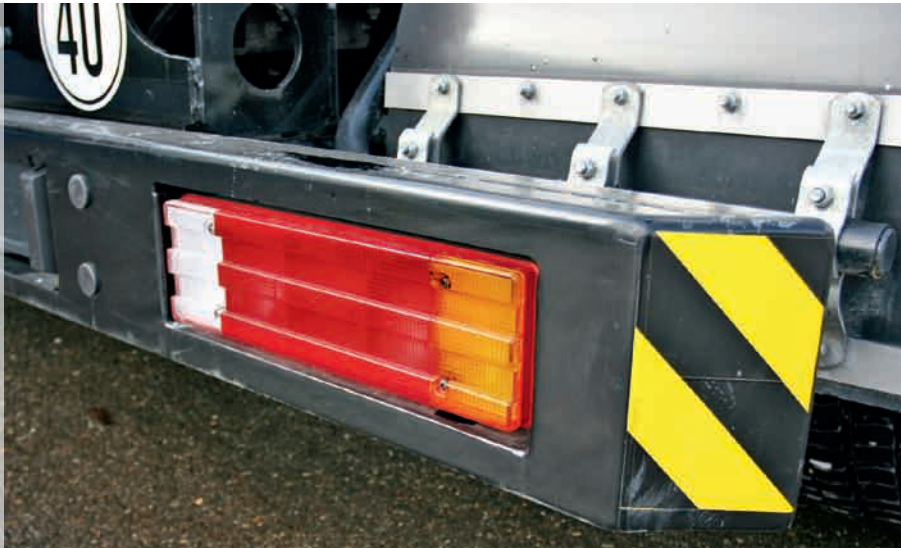
Bei einem effizienten Heckunterfahrschutz darf der Bodenabstand nicht zu groß sein.
