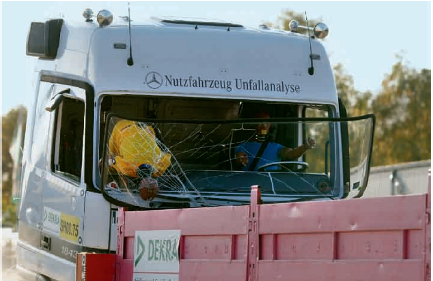
Auf dem DEKRA Nutzfahrzeugsymposium 2008 in Neumünster wurde der Unterschied von angegurtet und nicht angegurtet im Rahmen eines Crashtests eindrucksvoll unter Beweis gestellt.
