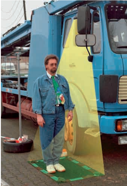
Vergleich alter und neuer Spiegel am Beispiel des Anfahrspiegels.
