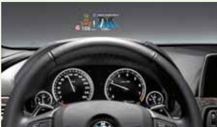
**Head-up-Display:** Anzeigesystem, bei dem die für den Nutzer wichtigen Informationen als virtuelles Bild über ein kleines Display im Sichtfeld des Fahrers projiziert werden. Damit muss der Fahrer den Blick nicht mehr von der Straße abwenden, um sein Tempo, die Infos der Verkehrszeichenerkennung beziehungsweise vom Nachtsichtsystem erkannte Fußgänger oder Radfahrer in den Anzeigen des Kombiinstrumentes abzulesen.
