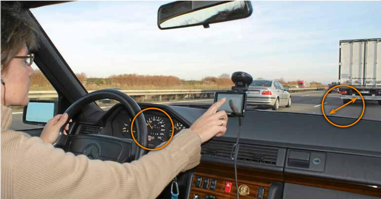
Auch die Bedienung eines Navigationsgerätes kann zu Unaufmerksamkeit führen. Der Sicherheitsabstand zum Lkw ist viel zu gering. Darüber hinaus entspricht die Anbringung des Navigationsgerätes nicht den Empfehlungen der EU-Kommission über sichere und effiziente Informations- und Kommunikationssysteme, wonach kein Teil des Systems die Sicht des Fahrers auf die Straßen behindern sollte.
