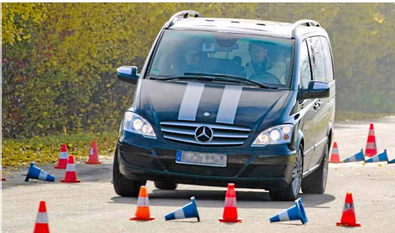
Sicher ausweichen bei einer Vollbremsung mit ESP und ABS.
