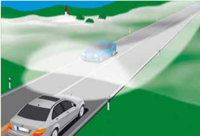
Verteilung des Standard-Abblendlichts bei Nebel (Bild: Daimler AG)
