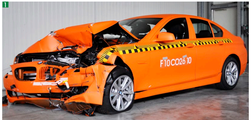
1 Beschädigung des mit 64 km/h gecrashten Fahrzeugs
