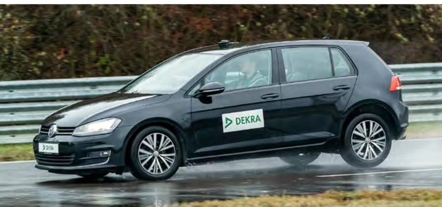
weglänge in mehreren Versuchen auf nasser Fahrbahn nahezu konstant 44,4 Meter. Anschließend wurden Reifen, Bremsen und Stoßdämpfer erneuert. Die Reifen wurden durch neue Winterreifen einer Premiummarke ersetzt. Die Bremsweglänge konnte so auf durchschnittlich 38,7 Meter reduziert werden.
