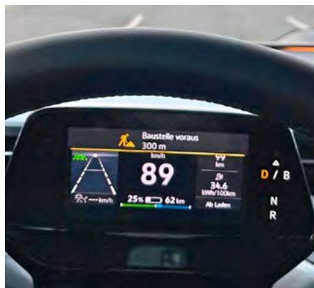
Das C-ITS-System zeigt im Cockpit rechtzeitig an, wie weit die Baustelle noch entfernt ist.
