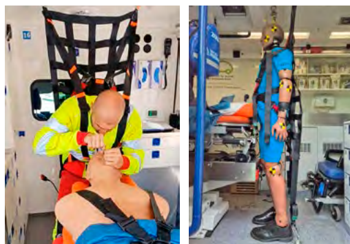
Notarzt im Netzgurt (links) und Einbau eines 50 Perzentil-Dummys im Netzgurt am Kopfende der Trage
