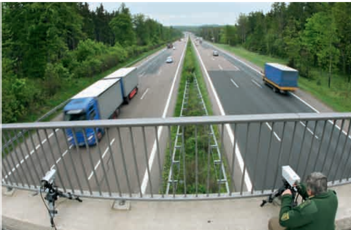
Grazie al radar si possono dimostrare il superamento dei limiti di velocità e la distanza di sicurezza insufficiente, con relative tolleranze.
