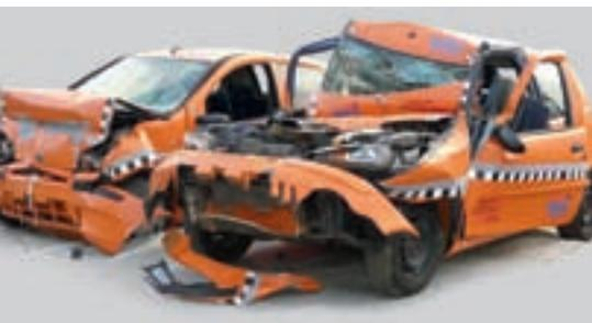
Protection latérale efficace : lorsqu'une voiture percute la caisse palette standard (utilisée jusqu'à présent), le choc engendre des déformations jusqu'à hauteur du dossier du siège conducteur. L'airbag ne se déclenche pas. Dans le second cas, les systèmes de sécurité passive installés à bord du véhicule particulier peuvent assurer leur fonction. La déformation s'arrête avant le pare-brise. L'airbag se déclenche.
