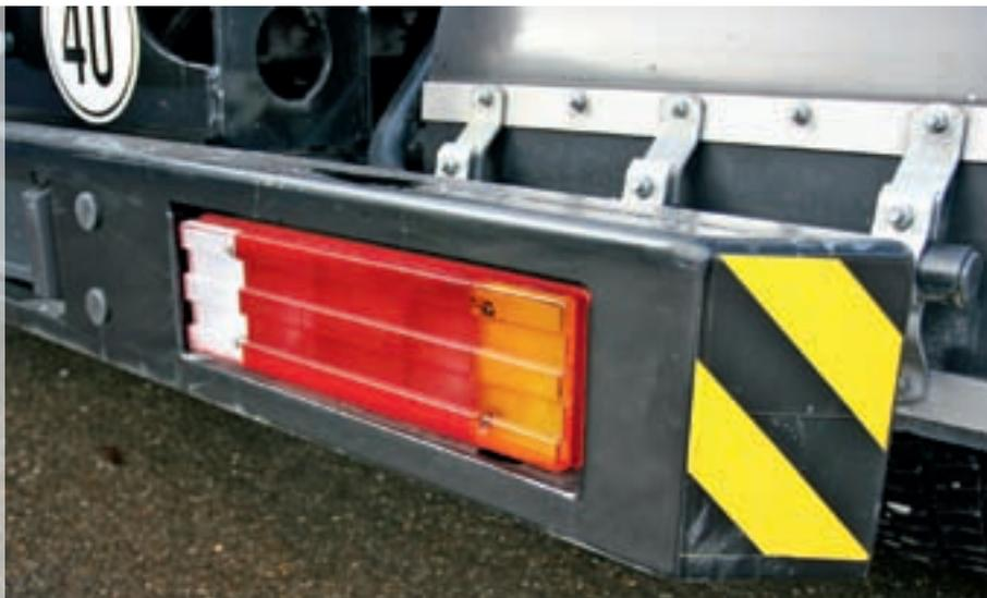
Pour qu'une protection anti-encastrement arrière soit efficace, la distance par rapport au sol ne doit pas être trop grande.
