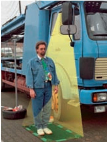
Comparaison des anciens et des nouveaux rétroviseurs – exemple du rétroviseur d'approche.
