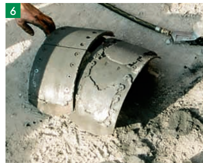
6 Guarnizione freni disintegrata a causa del surriscaldamento
