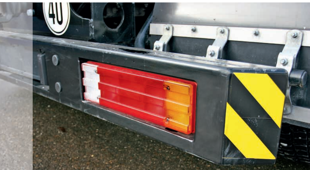
Per una efficiente protezione anticastro posteriore, la distanza dal fondo stradale non deve essere eccessiva.
