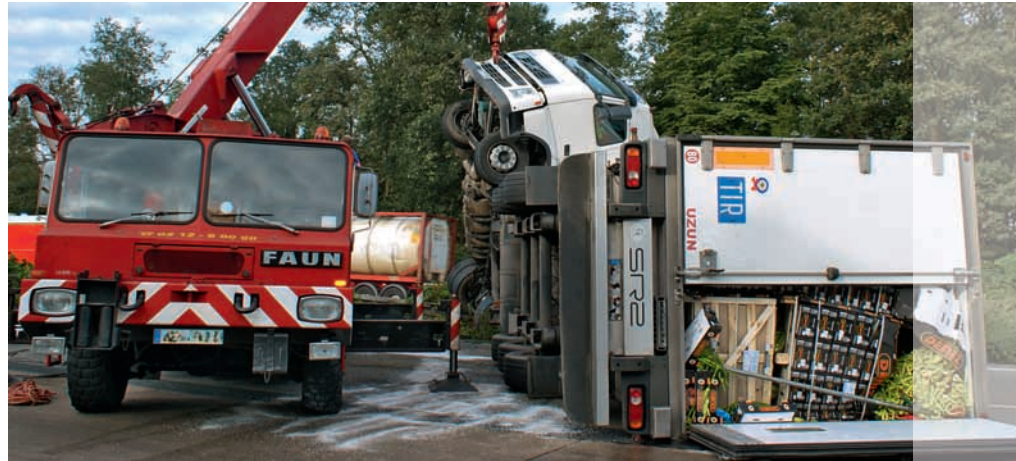
Dopo un incidente di un camion è spesso necessaria un'autogru per il recupero del veicolo e del carico trasportato.
