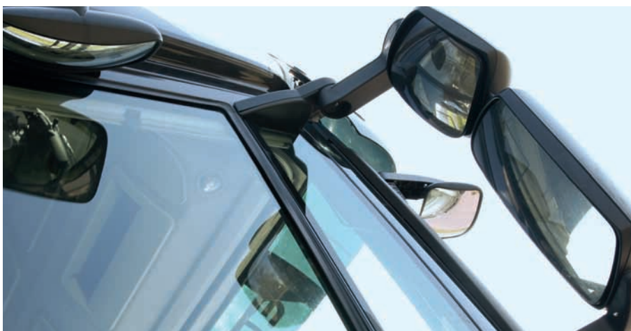
I nuovi sistemi di specchi miglioreranno il campo visivo indiretto del conducente di camion.
