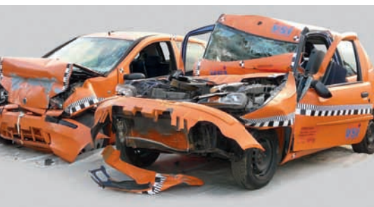
Protezione laterale efficace: in caso di urto di un'automobile con gli (attuali) pallet box standard, si verificano deformazioni addirittura oltre la spalliera del sedile conducente. L'airbag non si attiva. Nel secondo caso è invece possibile attivare il sistema di sicurezza passiva dell'automobile. La deformazione termina prima del parabrezza. L'airbag si attiva.
