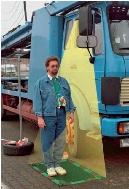
Confronto tra gli specchi vecchi e nuovi, utilizzando lo specchio retrovisore di prossimità.
