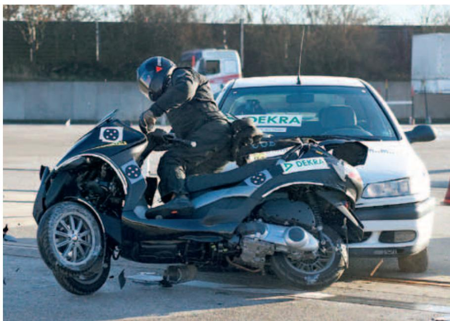
DEKRA procède régulièrement à des essais de collision de deux roues motorisés dans son Centre de crash-tests de Neumünster.
