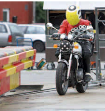
Crash-test della DEKRA per ottimizzare il sistema di protezione dei guardrail.
