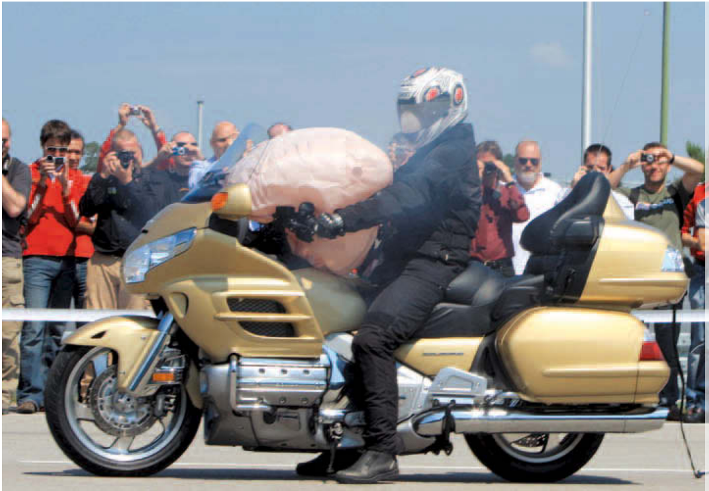
La Gold Wing della Honda nel 2006 è stata la prima moto ad avere l'airbag come dotazione di serie.
