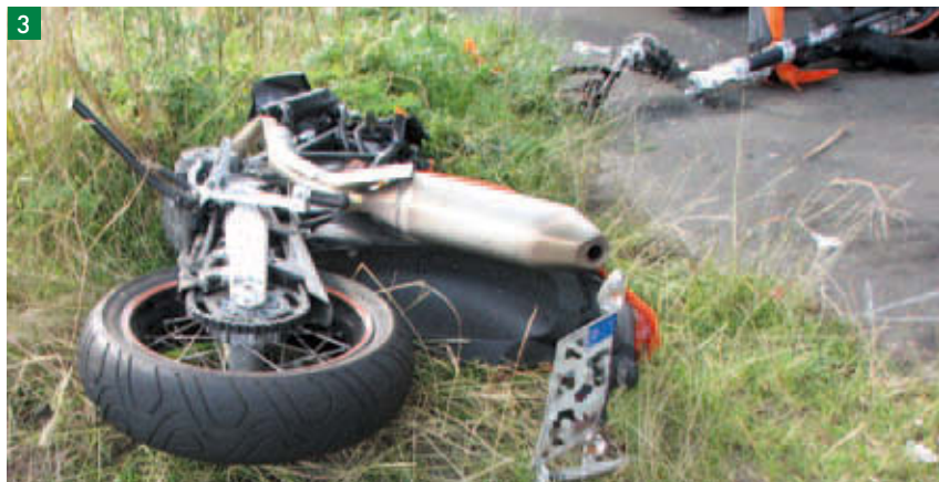
4 Danneggiamento del cerchio della ruota anteriore
