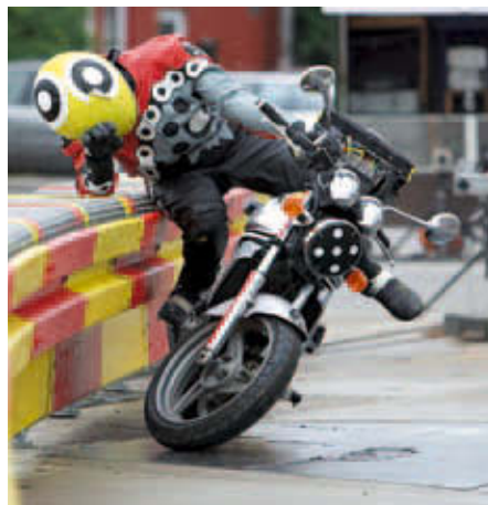
Crash-test della DEKRA per ottimizzare il sistema di protezione dei guardrail.
