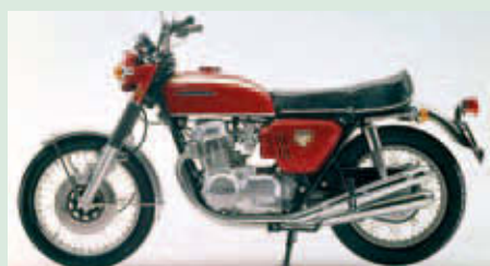
1969 Prima moto prodotta in serie con freni a disco (Honda CB750 Four)
