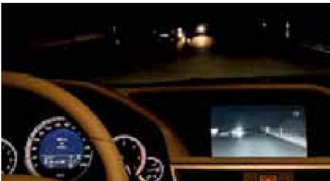
Image fournie par une caméra travaillant dans l'infrarouge proche et affichée sur l'écran central.
