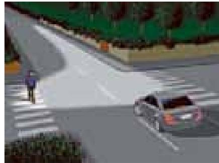
Zone de visibilité éclairée avec l'éclairage statique en virage lors d'une manœuvre de bifurcation vers la gauche.
