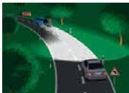
Zone de visibilité éclairée avec l'éclairage dynamique dans un virage à gauche.
