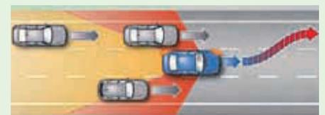
**Assistant d'angle mort/Blind Spot Monitoring :** Le système détecte les véhicules en arrière et sur le côté de la voiture. Il avertit le conducteur de leur présence, y compris dans l'angle mort, et contribue ainsi à sa sécurité de conduite.
