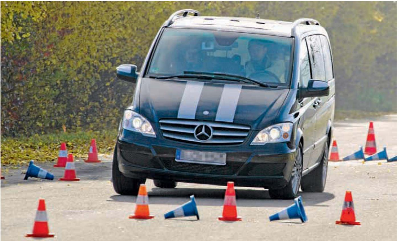
Freinage à fond et évitement sécurisés par l'ABS et l'ESP.
