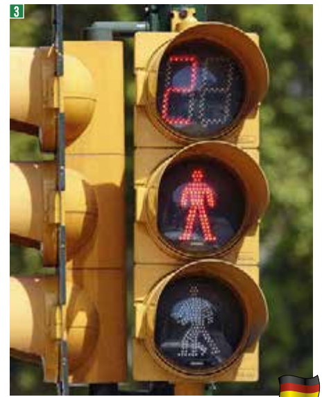
Fußgängerampel mit erweiterter Anzeige der verbleibenden Restzeit für Rotlicht
