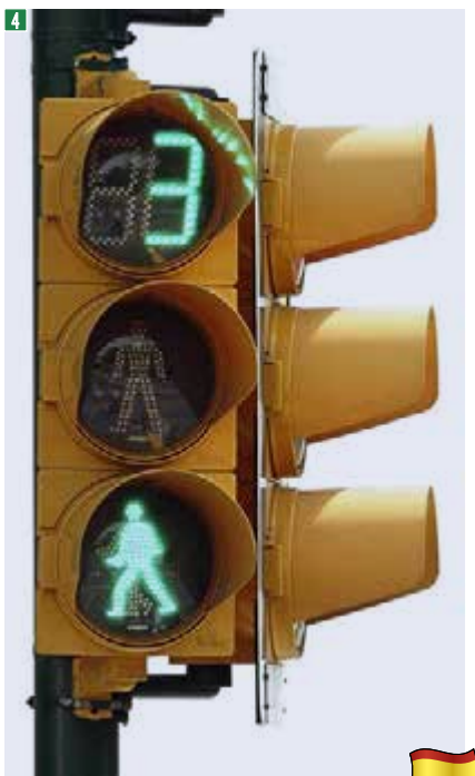
Ampel mit wechselweiser Anzeige von verbleibender Grün- bzw. Rotphase
