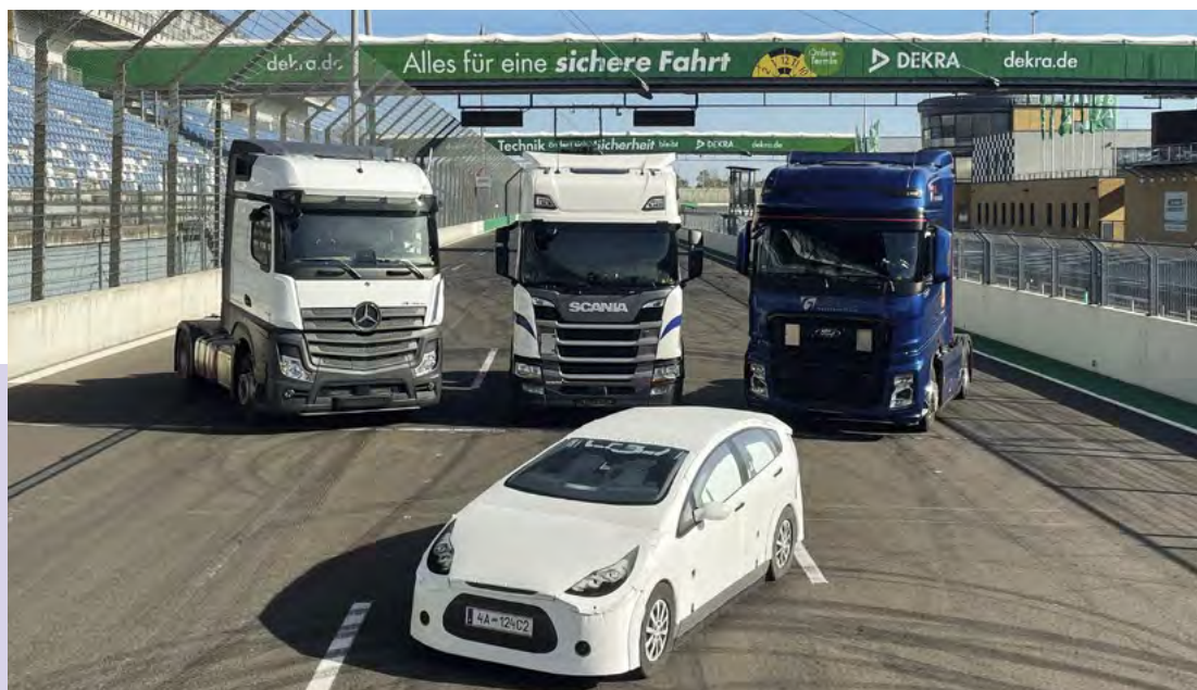
Dans le cadre d'essais de conduite avec des tracteurs de semi-remorques de trois constructeurs de poids lourds, DEKRA a testé l'efficacité des systèmes d'aide au freinage d'urgence montés dans les différents modèles.
