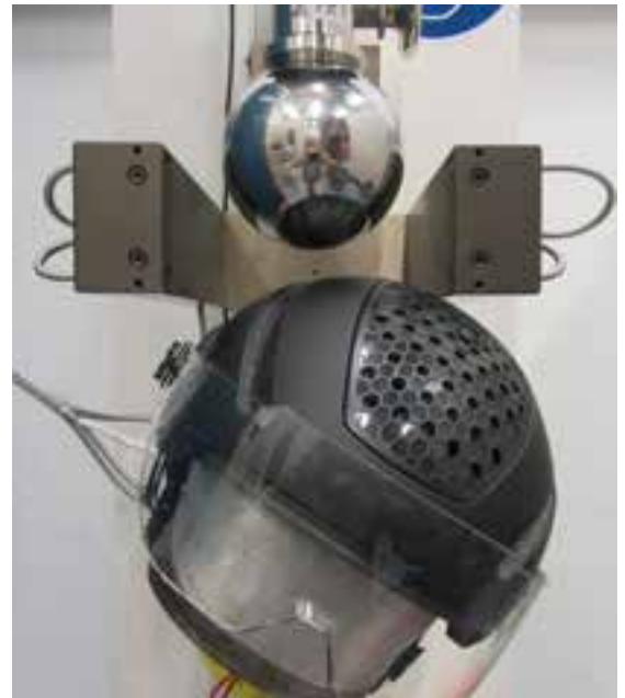
■ DEKRA realizó pruebas de impacto específicas con varios cascos.
