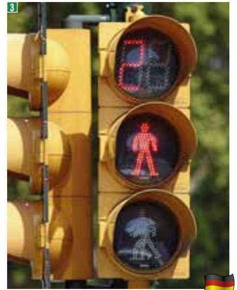
Semáforo peatonal con indicación ampliada sobre el tiempo restante de la fase de rojo
