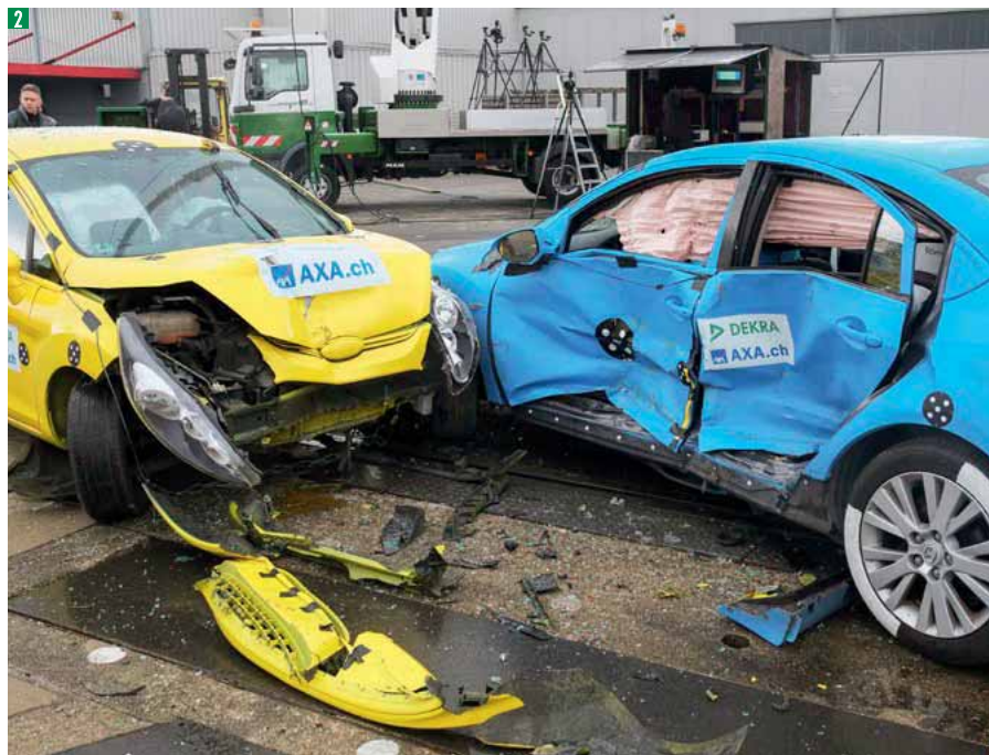
1 Colisión del nuevo Ford Fiesta con el Mazda 6 2 Airbag lateral desplegado así como faldones laterales y pilar B ofrecen una protección óptima a los ocupantes del Mazda.
