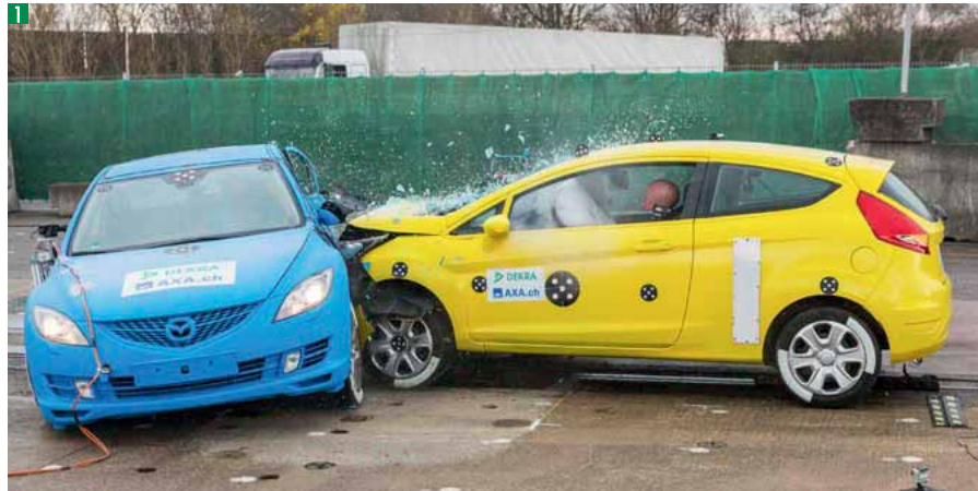
1 Colisión del nuevo Ford Fiesta con el Mazda 6 2 Airbag lateral desplegado así como faldones laterales y pilar B ofrecen una protección óptima a los ocupantes del Mazda.
