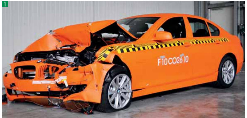
1 Daños del vehículo colisionado a 64 km/h
